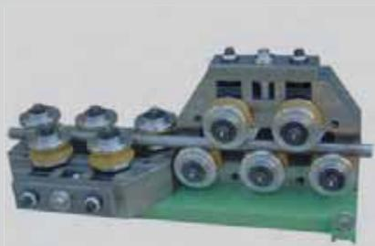
Raddrizzafilo in acciaio con rulli diametro 150 mm adatto alla lavorazione di fili tondi pieni da diametro 16 mm a diametro 30 mm, oppure cavi e tubi fino a diametro 45mm. Disponibile con regolazione manuale, manuale servo assistita con riduttore per consentire la regolazione manuale con minore sforzo, oppure con sistema di apertura/chiusura oleodinamico.
