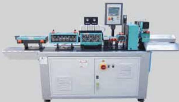
La macchina raddrizzafilo Cometo MTF è adatta alla raddrizzatura, taglio e smussatura opzionale di materiale con diametro da 0,8 a 10 mm. Grazie al sistema di raddrizzatura a rulli è adatta alla lavorazione di tondi, quadri, esagoni, e profili con qualsiasi altra forma ed è inoltre adatta a raddrizzare materiali come acciaio, leghe di rame o alluminio senza rovinare la superficie degli stessi.
