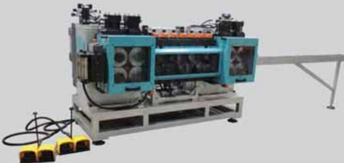
La macchina di raddrizzatura MRS180 è progettata per raddrizzare spezzoni di filo laminato a caldo presi a campione durante la bobinatura, da utilizzare per l'esecuzione del test di trazione in laboratorio. La macchina è costituita da 4 rulli motorizzati che spingono il filo in un raddrizzafile a rulli folli e da altri 4 rulli motorizzati che estraggono il filo dal raddrizzafile. La macchina è adatta a raddrizzare diametri da 5.5 a 26 mm.
