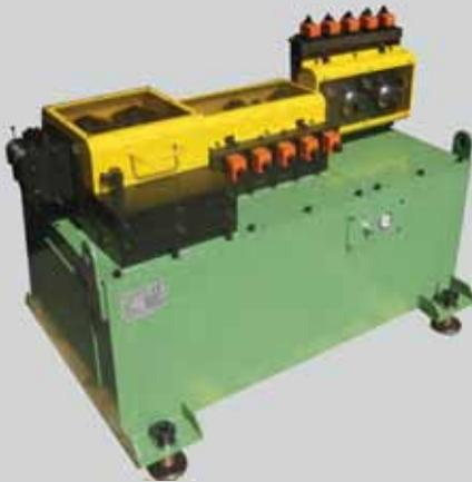
Macchina pre-raddrizzatrice utilizzabile come introduttore adatta a gamma fili da 14 a 30mm.
