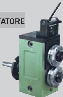
Alimentatore modulare per filo con dia. fino a 20mm e piattine. Fornito con 2, 4 o 6 rulli. Disponibile in due grandezze: AL6 con diametro rulli 65mm e AL12 con diametro rulli 122mm. Con sistema di spinta sui rulli in versione a vite, eccentrico, pneumatico e oleodinamico
